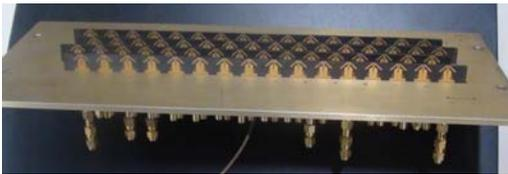
Figure. 2: (d) Antenna Elements arranged in (16 x4) array
